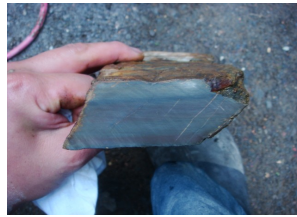
一つのがつ板の原石内部には、肌やしょんべんがねが介在しており、頁岩のもつ劈開性と質の不均質さによるポント強度の弱いところを狙い、鑿で鍛えをかける。
