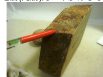
極めて確認困難だが、ペン先の一平面だけ、質が違うので鑿で開いて外す必要がある
