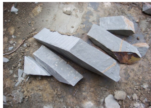
一つのがつ板の原石内部には、肌やしょんべんがねが介在しており、頁岩のもつ劈開性と質の不均質さによるポント強度の弱いところを狙い、鑿で鍛えをかける。
