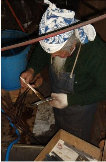
独自に配合した土を鋼の部分に塗る
