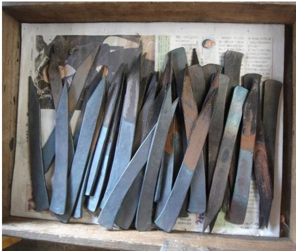
鋼側にごごむ為、それを見越して鍛造しているがどうしても、焼入れにより反ってしまう為焼入れ後155度で30分焼き戻しを行い、その後一本一本手作業による歪取りを行う。
